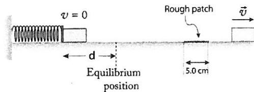
1.2 kg の物体がばね定数  $k = 730 \text{ N/m}$  のばねに接触している。ばねを  $d$  だけ圧縮した後、物体をはじき飛ばす。物体はまさつのない水平面を滑る。一カ所 5.0 cm だけ動摩擦係数  $\mu' = 0.44$  の部分を滑る。この部分を通過した後の速さは 2.3 cm/s である。 $d$  を求めよ。
