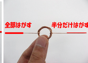
4) 一方のエナメルを全部 他方のエナメルは下側だけはがす Remove all enamel on one side & only the lower part on the other
