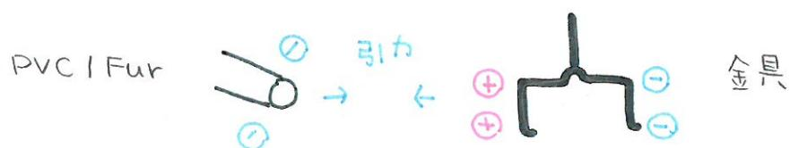
正に帯電させたガラス棒を金具に近づけると、その間に静電誘導が起こり、ガラス棒の正電荷と金具の負電荷の間に引力が生じ、お互いが引き合った。
